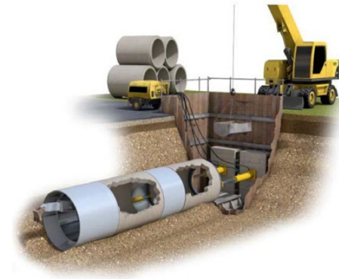
Ilustración 27: Método hincado de tubería mediante gatos hidráulicos.
