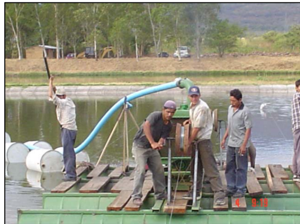
Figuras 11 – Balsa con bomba centrífuga para la extracción de lodos “vía húmeda”
