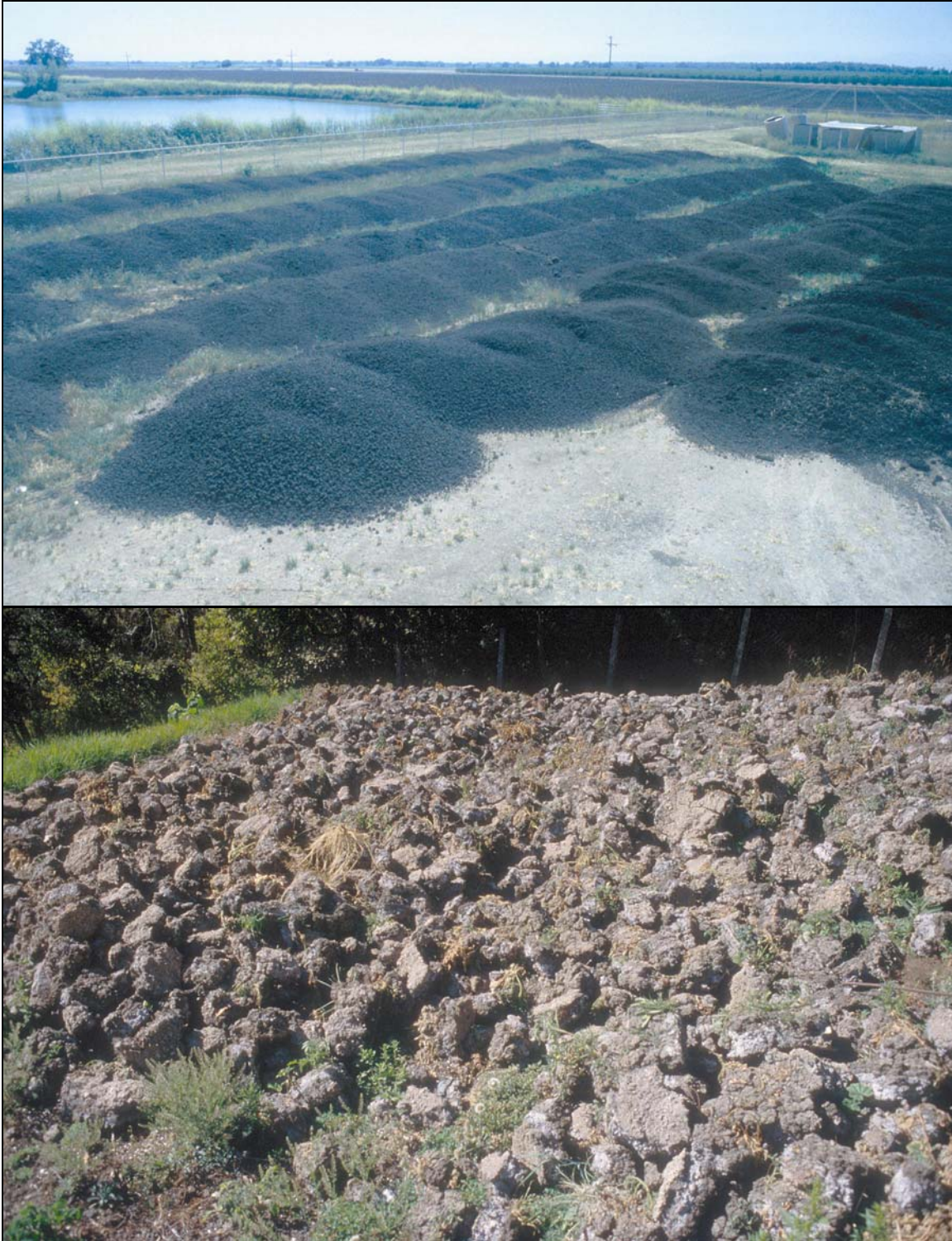
Fotos 8-4: Ejemplos de lodos secos que están almacenados en zonas especiales reservados para ellos en las plantas de tratamiento de aguas residuales. Por el riesgo de los huevos de helmintos, los lodos deben ser almacenados por los menos un año y, antes de cualquier uso o disposición final, analizados por huevos viables de helmintos. (Foto arriba: Planta de tratamiento de Chico, California, EE.UU.; abajo: Planta de tratamiento de San Juan Comalapa, Guatemala)
