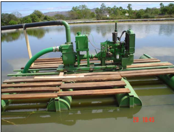
Figuras 11 – Balsa con bomba centrífuga para la extracción de lodos “vía húmeda”
