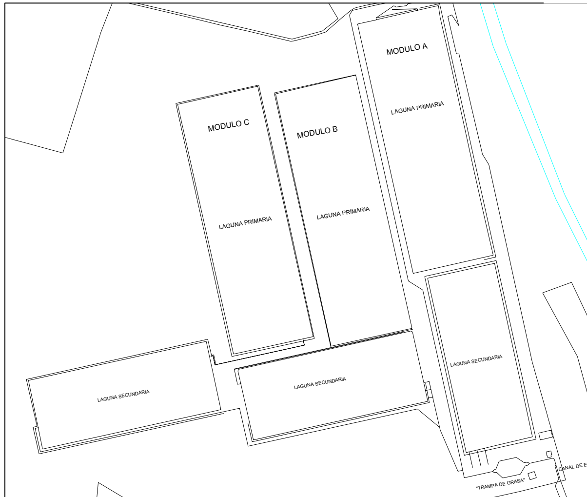
Figura 2—Sistema de tratamiento de aguas residuales de la ciudad de Estelí (antes de la RMA)
