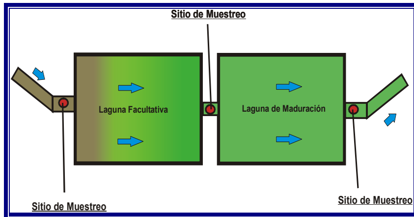
Figura 2-1: Esquemas Mostrando la Ubicación de Puntos de Muestreo entre Lagunas
