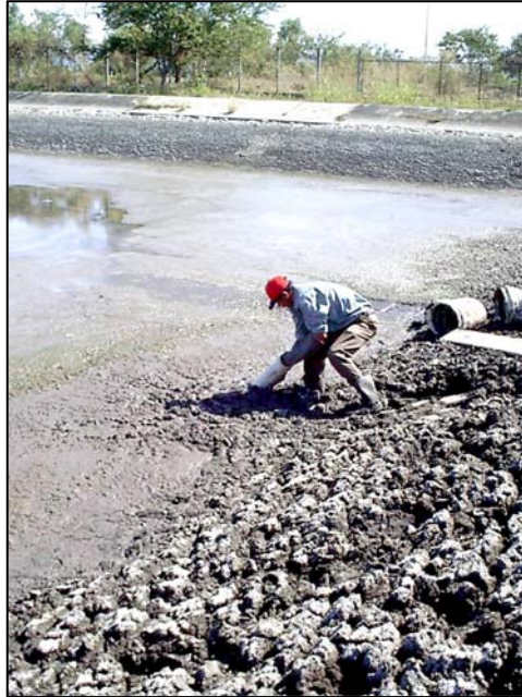
Figura 20– Toma de muestra de los lodos de la laguna primaria “A” (entrada)
