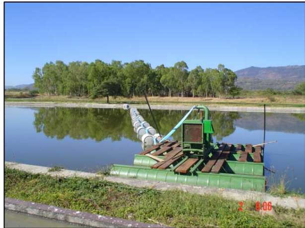
Figuras 13 –Manguera de impulsión sobre el agua
