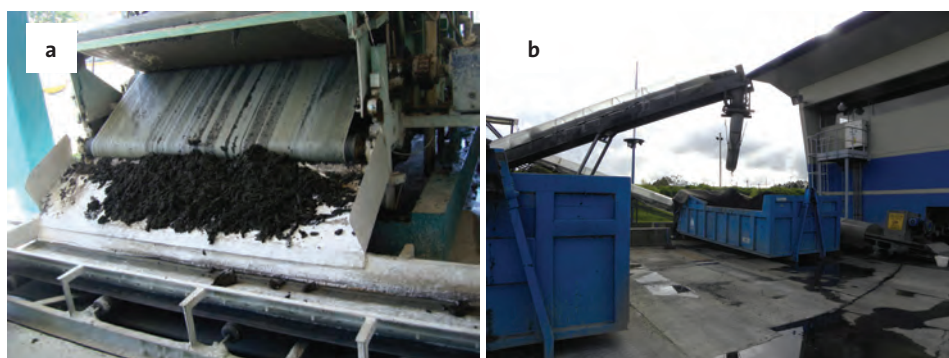
Figura 1.18. a) Filtro banda de la planta de tratamiento de aguas residuales Sur, Querétaro, México, b) Manejo de lodos residuales de la planta de tratamiento de aguas residuales de la Calera, Colombia.
